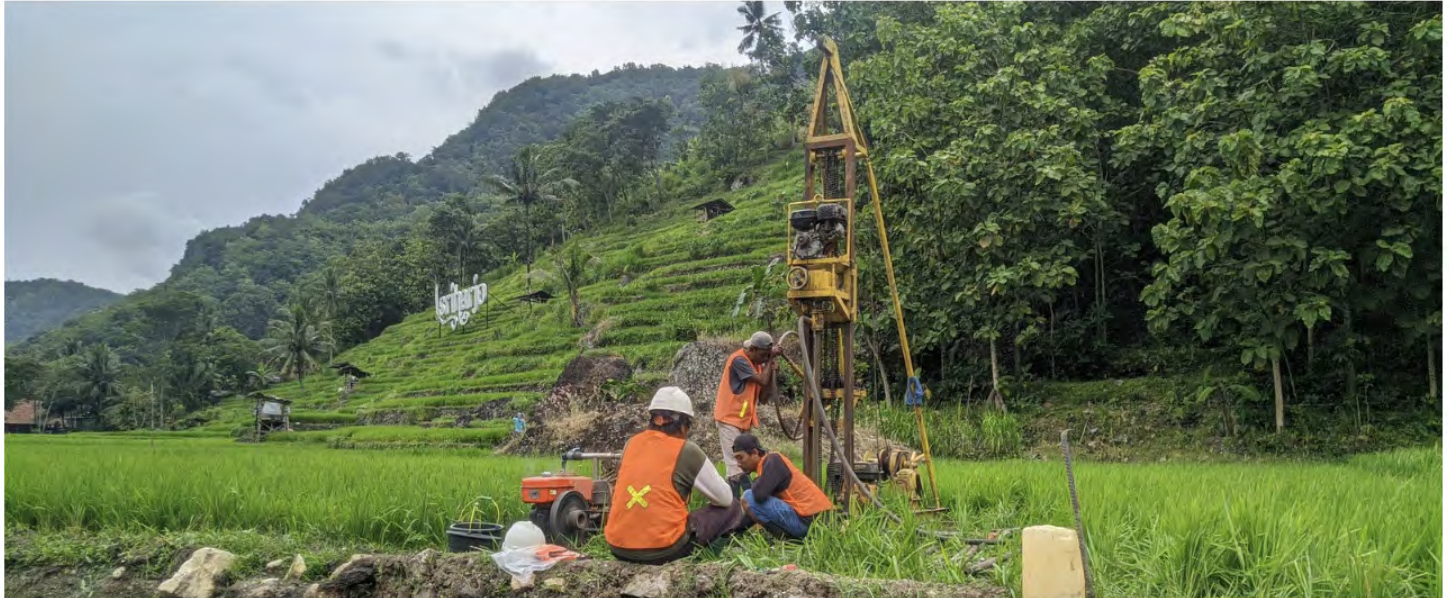
■ Foto Tim Universitas UGM melakukan pengeboran untuk mencari tahu penyebab jalan ambles di Wunut (Dok. Humas Bantul)
